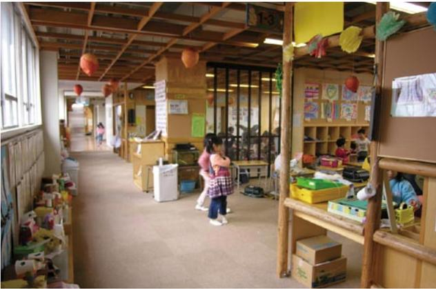
教室と廊下との間の壁を撤去し、廊下部分までを一体的に利用している。また、耐震壁以外の教室間の界壁にも開口を設け隣の教室との一体感を出している
